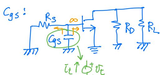
$$\begin{cases} G = C_{gs} \\ R_i = R_s \end{cases} \quad \begin{cases} T_i = R_s + G_{ds} \\ T_d = R_d + G_{ds} \end{cases}$$
